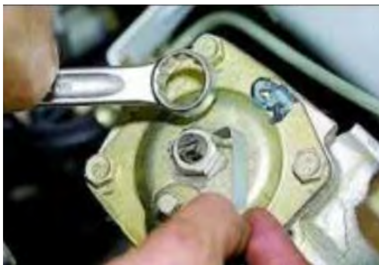
Рисунок 3.4 – Регулювальний гвинт із контргайкою рульового механізму
