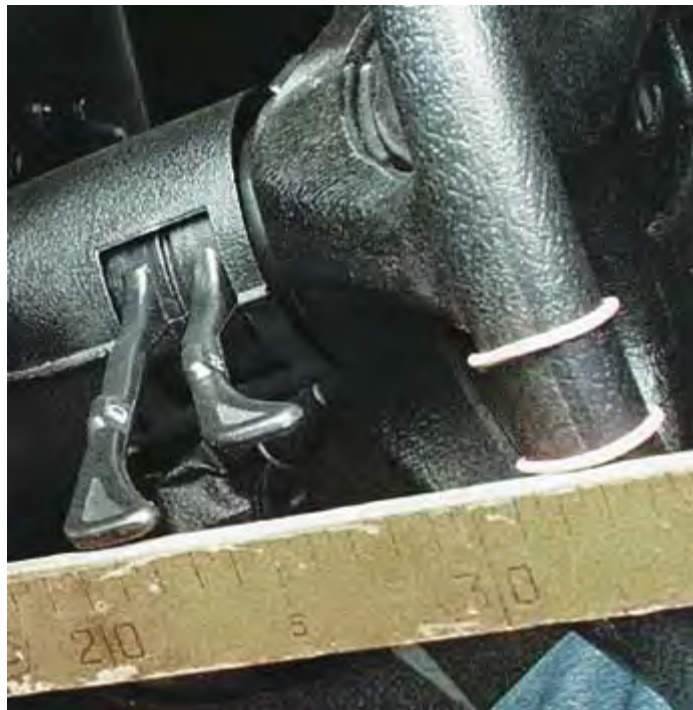
Рисунок 3.6 – Встановлення маяків на кермі для визначення вільного ходу кульового колеса
