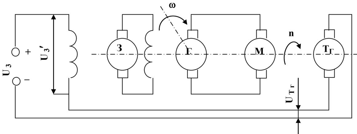
Рисунок 2.6 Електрична принципова схема живлення електродвигуна і регулювання швидкості обертання М – двигун; Г – генератор;
