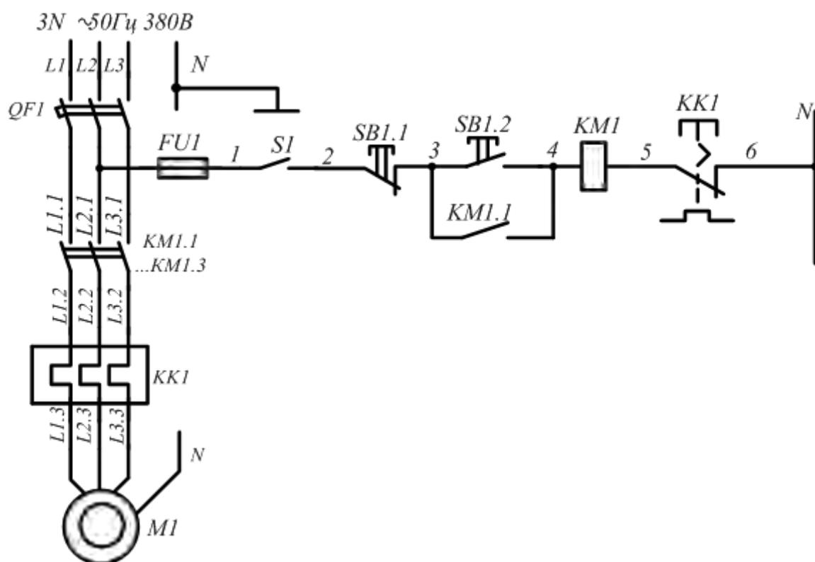
Рис. 3- Позначення кіл з урахуванням їх функціонального призначення Ділянкам ланцюга, що проходять через рознімні контактні з'єднання, допускається присвоювати різне позначення.
