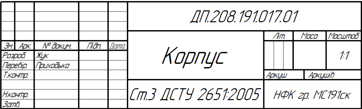
Рисунок 5.24 – Кутовий штамп на оборотній стороні формату А4
