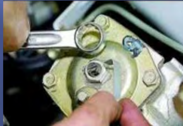
Регулювальний гвинт із контргайкою рульового механізму
