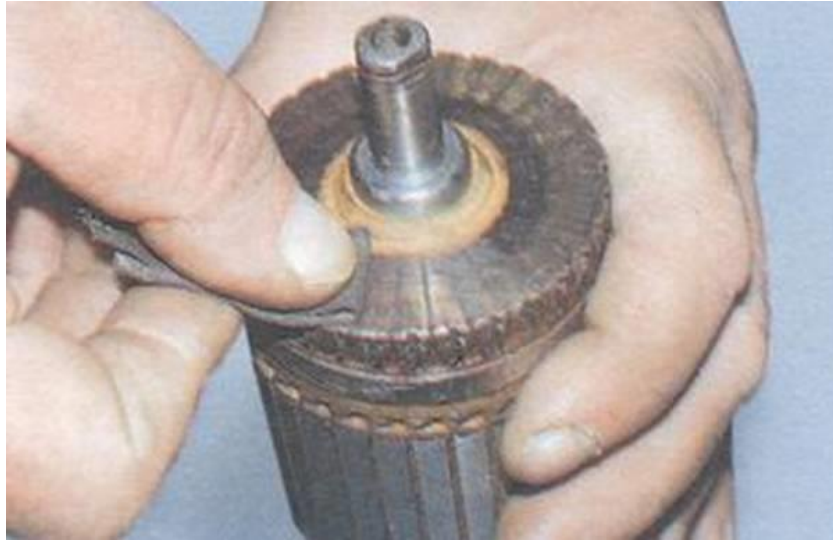
Рисунок 3.9 – Очистка якоря стартера від нагару
