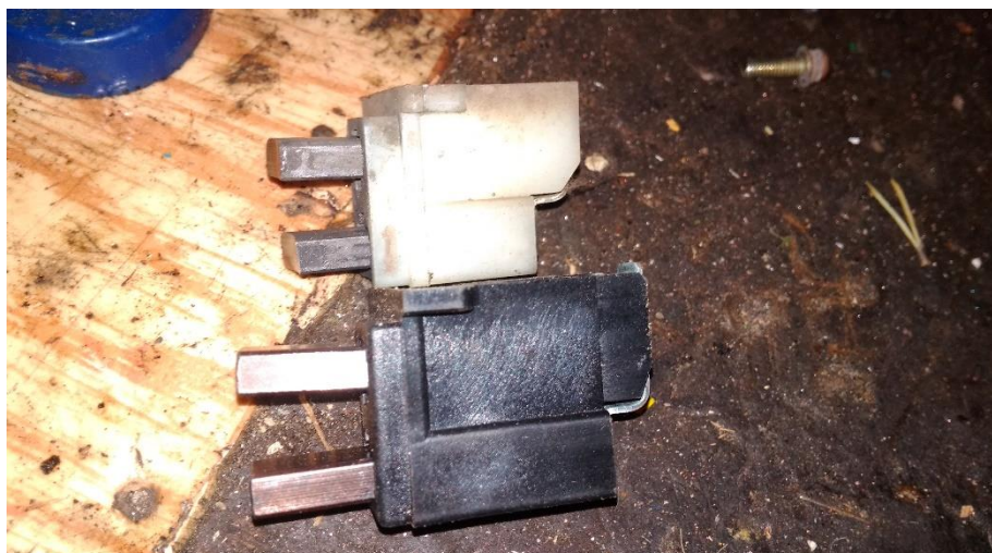
Рисунок 3.2 – Порівняння нових і зношених щіток
