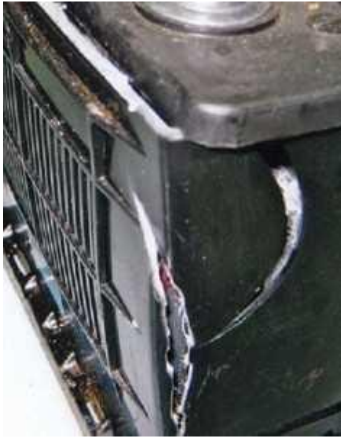
Рисунок 3.1 – Тріщини на корпусі акумуляторній батареї
