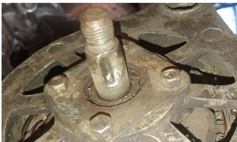
Рисунок 3.3 – Розбитий паз під шпонку через пошкодження шківів
