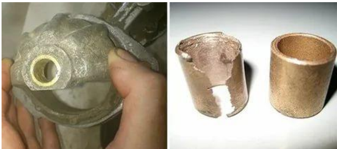
Рисунок 3.10 – Знос втулки якоря стартера
