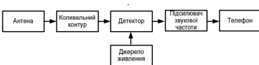
Рисунок 4.2 – Структурна схема радіоприймального пристрою
