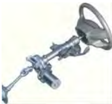
Рисунок 1. Рейковий рульовий механізм американського автомобіля ChevroletCobalt з електропідсилювачем
