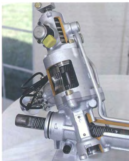
Рисунок 5. Блок «планетарний редуктор-електромотор системи AFS
