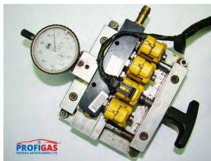
Рисунок 5 – Перевірка форсунок на стенді.
