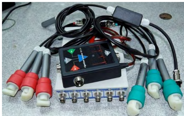
Рисунок 2. USB осцилограф для діагностування двигунів внутрішнього згорання
