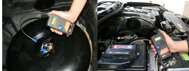
Рисунок 3 – Перевірка герметичності системи.
