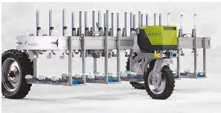
Рис. 5. Роботизований комбайн для м'якого збирання полуниці.
