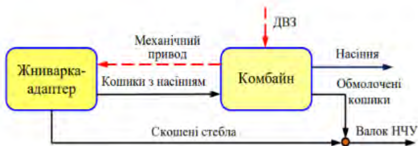
Рис. 2 – Структурна схема розділення потоків технологічних матеріалів при збиранні соняшнику зернозбиральним комбайном
