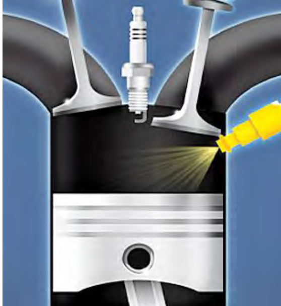
Рисунок 2 Принцип подачі палива при системи безпосереднього впорскування палива
