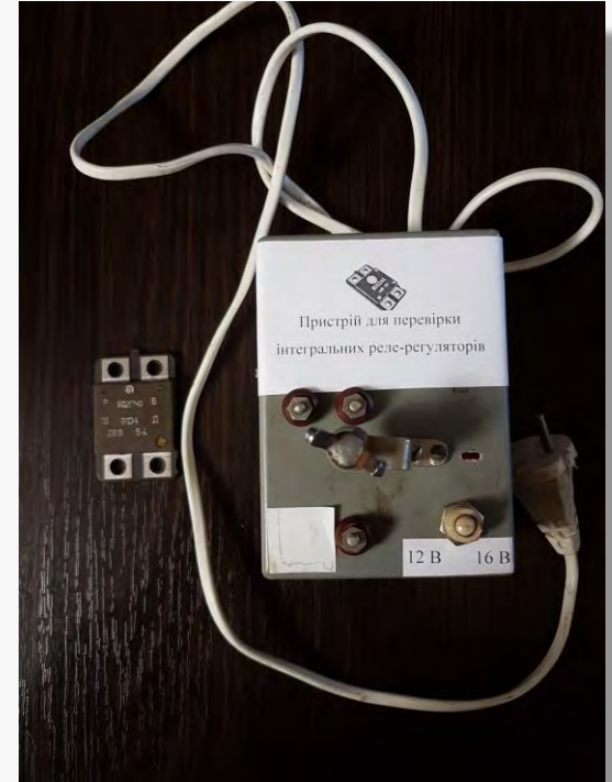
Пристрій для перевірки інтегральних реле-регуляторів генераторних установок автотракторної техніки
