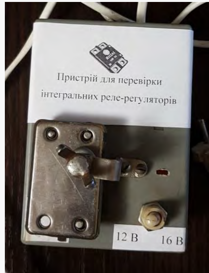
Пристрій для перевірки інтегральних реле-регуляторів генераторних установок автотракторної техніки
