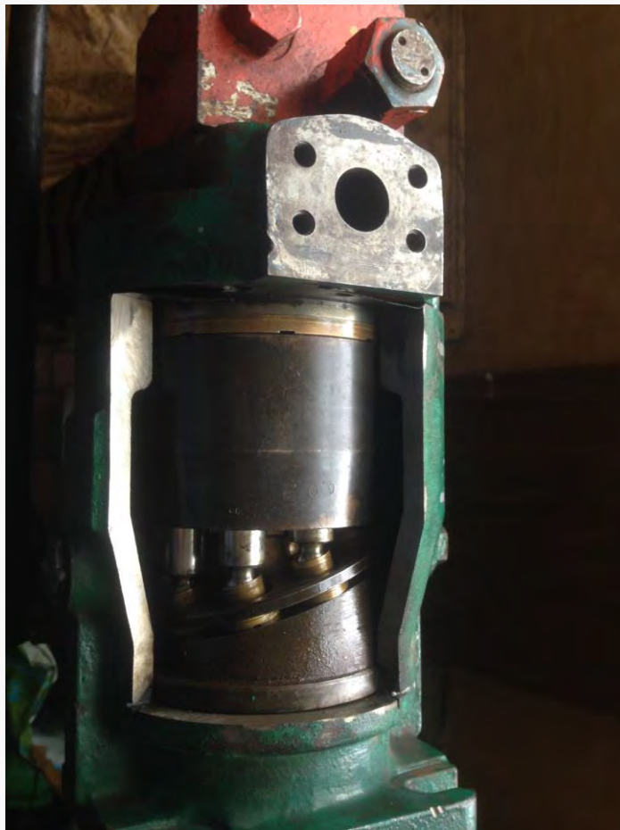
Розріз аксіально- плунжерного насоса (створення навчального макета)
